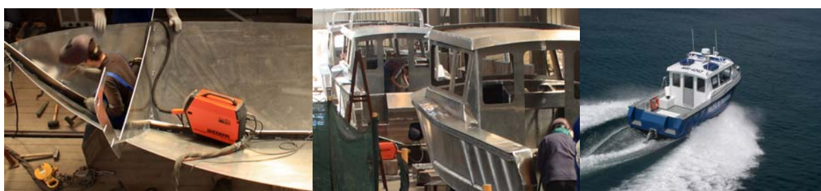
Slika br. 6 Tehnomont Brodogradilište Pula d.o.o. - Onix 26 patrolna brodice duljine 8 m, Isporuka: 09/2010, Brzina: 35 čv, Pogon: Volvo D4-260DP, Materijal gradnje: aluminij
