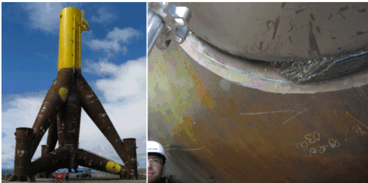
Slika br. 7 M5000 Vjetrenjača postolje-strukture, Masa: 700t, Materijal: S355, Promjer glavne cijevi: 4000-6000 mm, Promjer cijevi grana: 2000-4500 mm, debljine stijenke glavne cijevi: 90 mm, debljine stijenke grane: 30-40 mm
